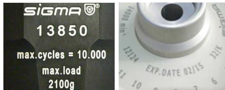
Abb. 5.7: abweichende Lebensdauer – Gravur auf dem Becher / Rotor
