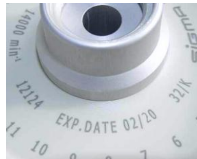
Abb. 4: abweichende Lebensdauer – Gravur auf dem Becher / Rotor
